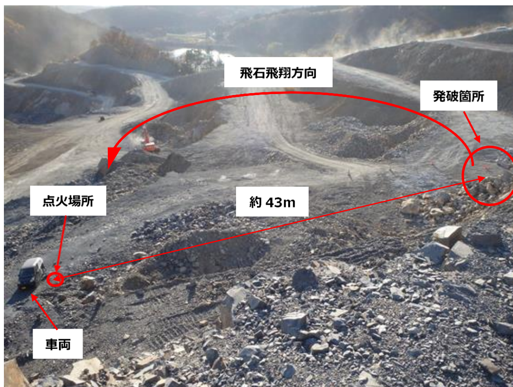
写真1 発破箇所と点火場所の位置関係
